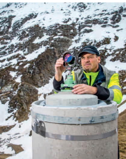
Mittels Lasermessung untersuchen die Dammwärter die Bewegungen der Talsperre. Es sind nur Millimeter.
