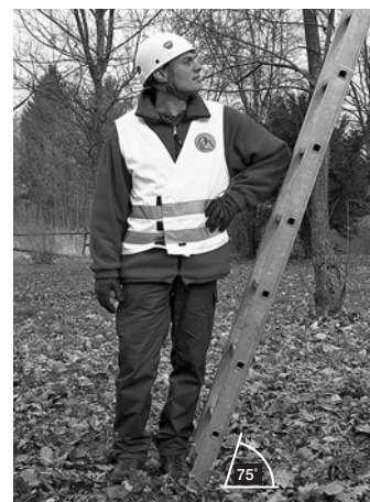
Bild 2: Die richtige Neigung lässt sich mit der Ellbogenprobe bestimmen. Bei einem Anstellwinkel von etwa 75° stehen Leitern am sichersten und können am bequemsten bestiegen werden.
