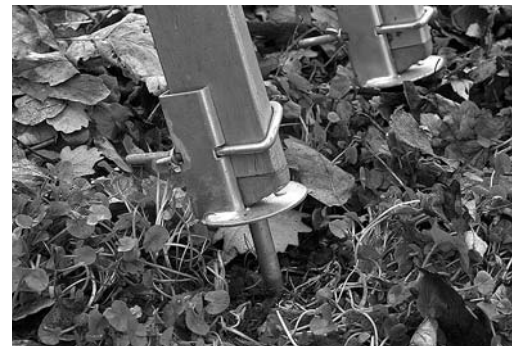
Bild 3: Auf weichem Boden dienen Metallspitzen als Rutschsicherung.
